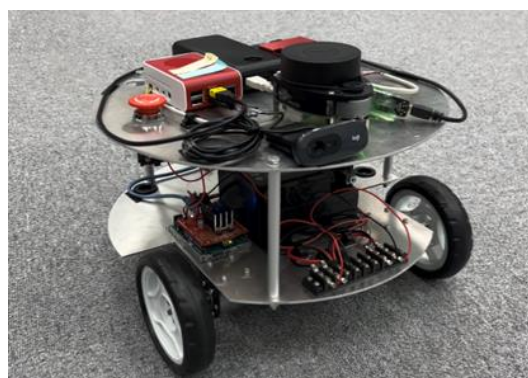
写真 1. 環境マップ作成機能を搭載した走行車両
