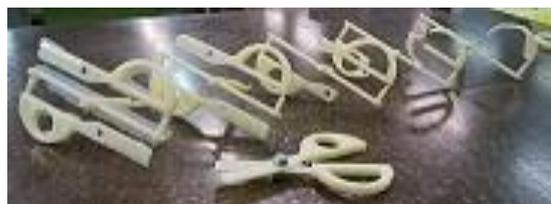
図 9 成形品の充填過程と完成品
