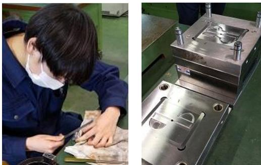
図 7 入子調整（左）と完成した金型（右）
