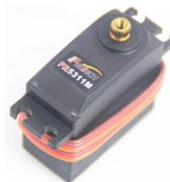
図 9 ラジコンサーボモータ
